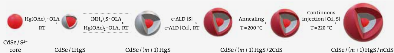
Рис. 21. Квантовые точки представляют собой ядро из селенида кадмия, прослойку из сульфида ртути в оболочке из сульфида кадмия: CdSe/HgS/CdS [165]
