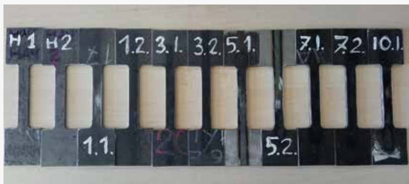
Рис. 1. Исследуемые образцы из стали 65Г после резки из листа Fig. 1. The studied samples made of 65G steel after cutting from a sheet
