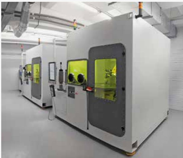
Рис. 5. Установка прямого лазерного выращивания ИЛИСТ-L Fig.5. Direct laser deposition complex ILIST-L
