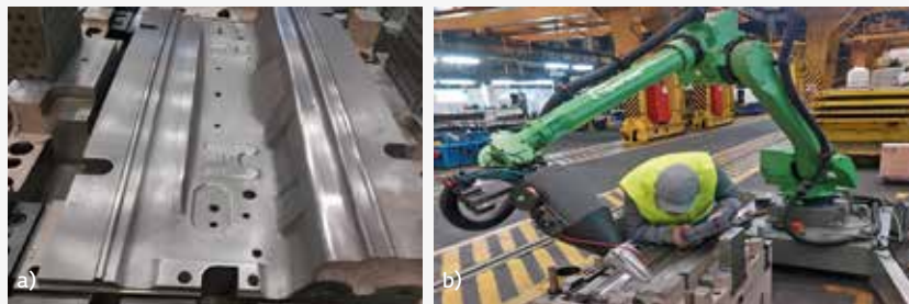
Рис. 2. Лазерная заправка матрицы штампа холодной штамповки из чугуна на предприятии АО «АВТОВАЗ»: а) матрица штампа холодной штамповки; б) процесс наладки лазер-робота МЭЛ-3.0 на выполнение операции заправки Fig. 2. Laser hardening of a cold-forming cast-iron die at AVTOVAZ JSC: a) cold-forming die; b) setting-up process for the MEL-3.0 laser robot to perform the hardening operation
