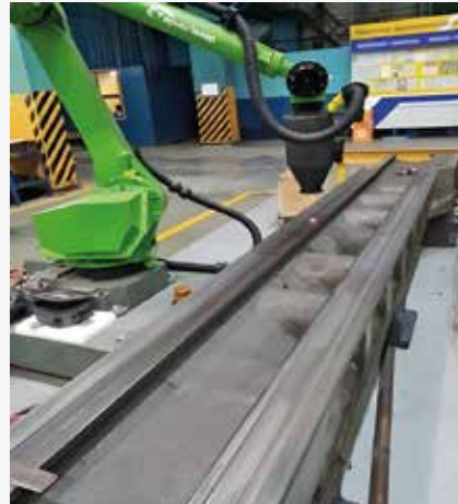
Рис. 4. Процесс лазерной закалки чугунных направляющих станины на ОАО «БЕЛАЗ» Fig. 4. Laser hardening process of the cast iron bed guides at BELAZ OJSC
