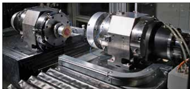
Рис. 7. Расположение шпиндельных узлов токарно-фрезерного станка модели УТМ-250.01 (ось Z – шпиндель изделия, ось X – инструментальный шпиндель)
