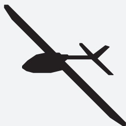
Рис. 4. Пример результата бинаризации изображения БВС на основе пороговой обработки Fig. 4. An example of the UAV image binarization result based on thresholding
