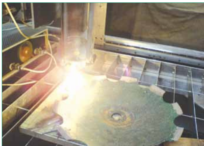
Рис. 2 Фрагмент лазерной наплавки порошковых покрытий
