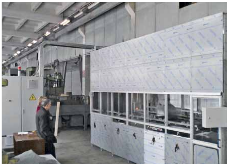
Рис.2. Комплекс АКР-3 обеспечивает удобство обработки: ванны, столы загрузки и выгрузки смонтированы в едином каркасе
