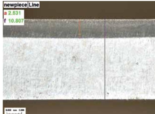
**Рис.3. Микрошлиф зоны закалки стали 40ХН2МА при мощности излучения 4000 Вт**
