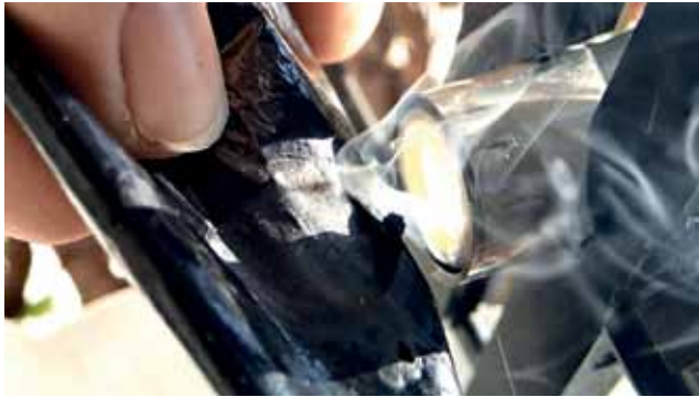
Рис.7. Сфокусированный этой самодельной желтой эпоксидной линзой (диаметром 16 мм с фокусным расстоянием 5 мм) солнечный свет поджигает копировальную бумагу
