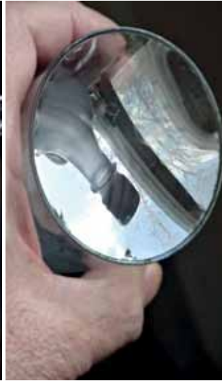
Рис.2. Зеркальное отражение от застывшей мыльно-желатиновой пленки диаметром 57 мм разной кривизны Fig. 2. Specular reflection from the solidified soap-gelatin film with the diameter of 57 mm and various curvatures
