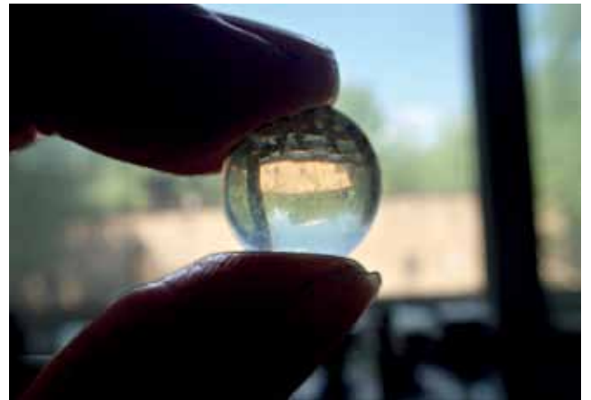
Рис.5. Полученная на пленке (рис.4) самодельная эпоксидная линза диаметром 16 мм с фокусным расстоянием 5 мм
