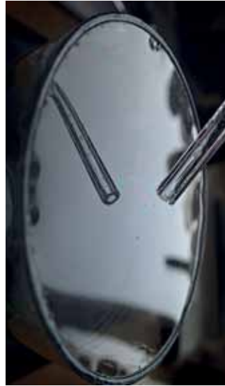
Рис.2. Зеркальное отражение от застывшей мыльно-желатиновой пленки диаметром 57 мм разной кривизны Fig. 2. Specular reflection from the solidified soap-gelatin film with the diameter of 57 mm and various curvatures
