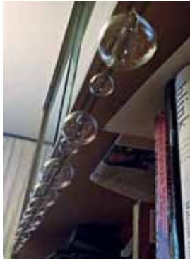
Рис.1. Гирлянда мыльно-желатиновых пузырей диаметром 3–5 см на ниточке с временем жизни больше недели Fig. 1. Chain of soap-gelatin bubbles with the diameter of 3–5 cm on the thread and life period of more than one week
