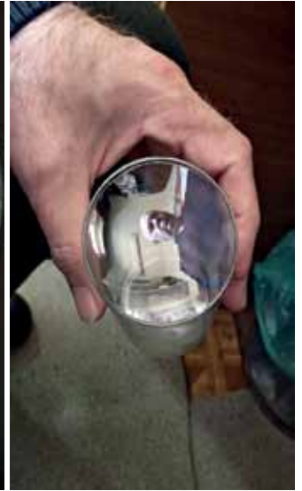
Рис.2. Зеркальное отражение от застывшей мыльно-желатиновой пленки диаметром 57 мм разной кривизны Fig. 2. Specular reflection from the solidified soap-gelatin film with the diameter of 57 mm and various curvatures
