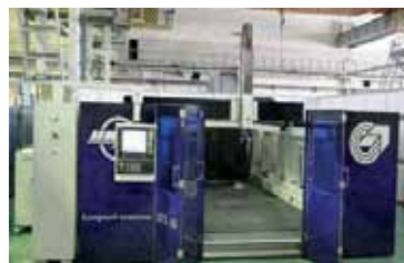
Рис.1. Пятикоординатный лазерный станок ЛТК-3D Fig. 1. ЛТК-3D Five-Axis Laser Technological Facility
