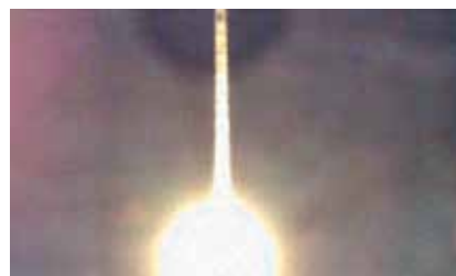
Рис.3. Процесс роста монокристаллического волокна оксида алюминия
