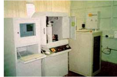
Рис.2. Пятикоординатный лазерный станок для финишной доводки керамических стержней
