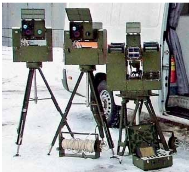
Рис.6. Оптико-механические блоки мобильного помехового комплекса МПЛ-2
