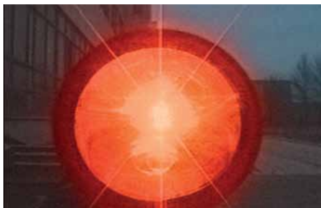
Рис.4. Полная блокировка всего поля зрения прицела встречным лазерным излучением
