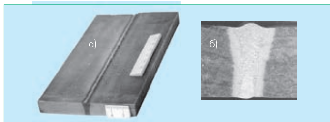
Рис.6 Внешний вид стыкового сварного соединения (а) и макрошлифа (б) из стали 22К толщиной 12 мм. Сварка выполнялась на CO 2 -лазере "Ижора-М" [11,19]. Мощность 9 кВт, V св = 55 м/ч, гелий
